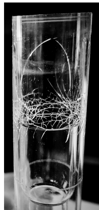
図 4. 蜘蛛の巣状の亀裂が入った石英製ベッセル
