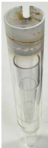
図 1. 5% HNO 3 中の Li、Na、Cs の 1.5% TDS 溶液を 24 時間分析した後の石英製外部チューブセットの失透
