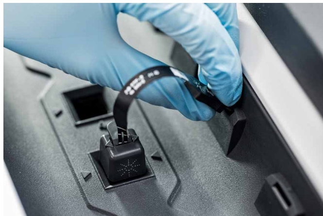
図 15. 温度プローブコネクタがシステムに接続される様子
