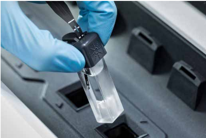
図 11. Cary のキュベット内温度プローブは、軽量で、表面積が大きく、サンプルの温度をすばやく反映させます。
