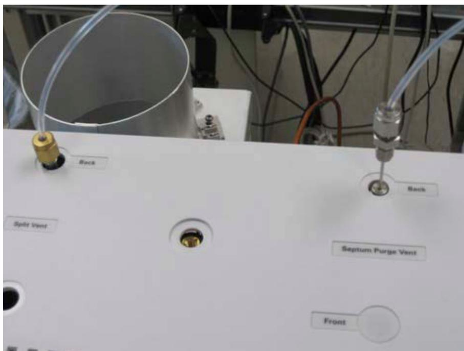
Figure 2. 設置された各注入口のスプリットベントとセプタムパージベントは、陰圧のラボベントシステムに接続する必要があります。
