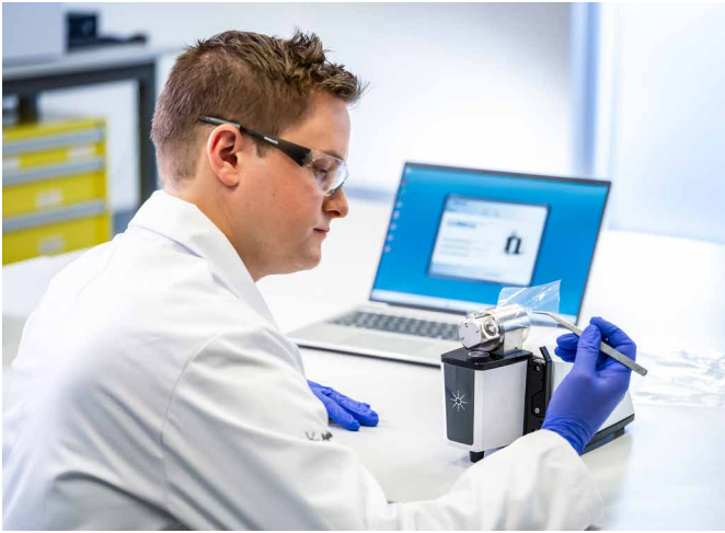
図 3. DialPath アタッチメントは、ポリマーフィルムの測定に使用できます。
