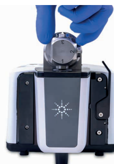
図 2. 液体サンプルの分析。DialPath アタッチメントを使用した 3 ステップ分析
