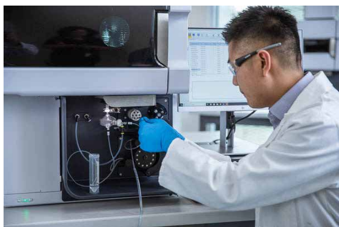
図 5. Agilent 5900 ICP-OES のサンプル導入システムに統合された AVS 7 アクセサリ
