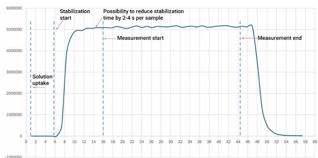
図 11. この Timing Monitor 表示では、Mn 信号は 12 秒で安定化していますが、測定は 16 秒に開始されています。測定を 12 秒に開始すれば、サンプルあたり最大 4 秒の時間短縮が可能です。
