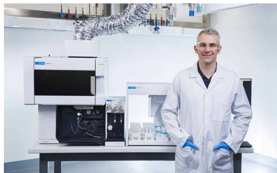
図 10. ICP 自動化システムは、装置本体、オートサンプラ、AVS 切り替えバルブ、および ADS 2 自動希釈装置で構成されています。
