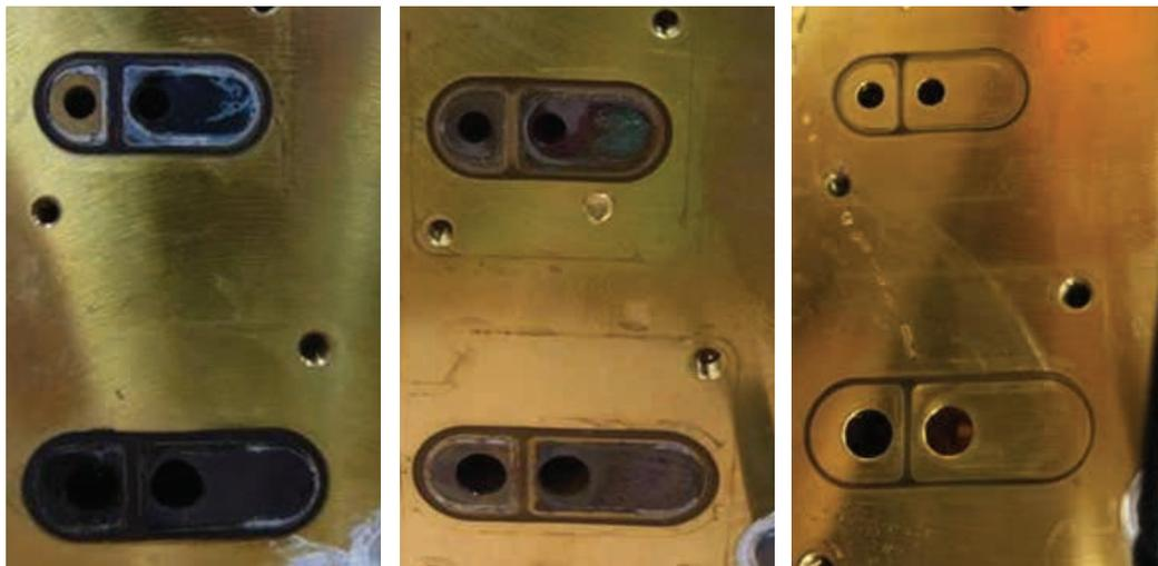
脱イオン水で 4 か月使用した後の状態。暗くなった部分から、内面の腐食が簡単にわかります。非純正冷却液を使用した場合と比較して、劣化がはるかに悪い状態であることが観察されました。
