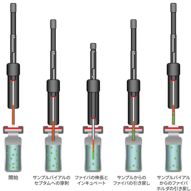
図 1. SPME プロセス - 直接浸漬 (DI) の例を示しています。
