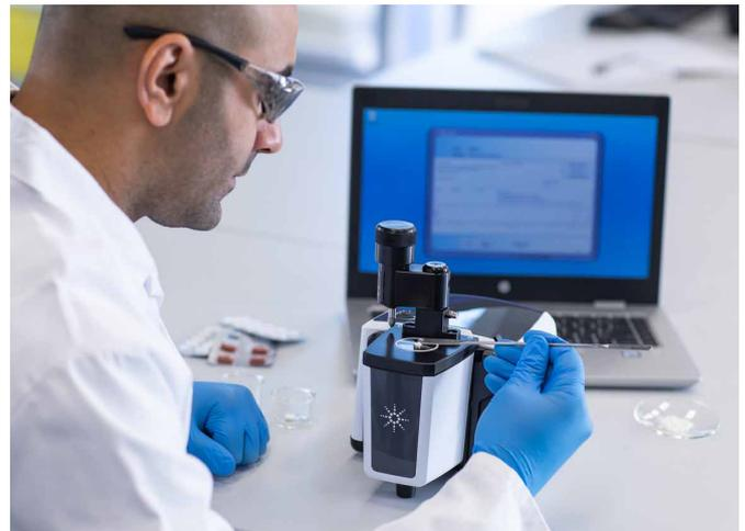
図 1. ダイヤモンド ATR サンプリングモジュール付き Agilent Cary 630 FTIR を用いて、異なる粉末の同定を確立します。
