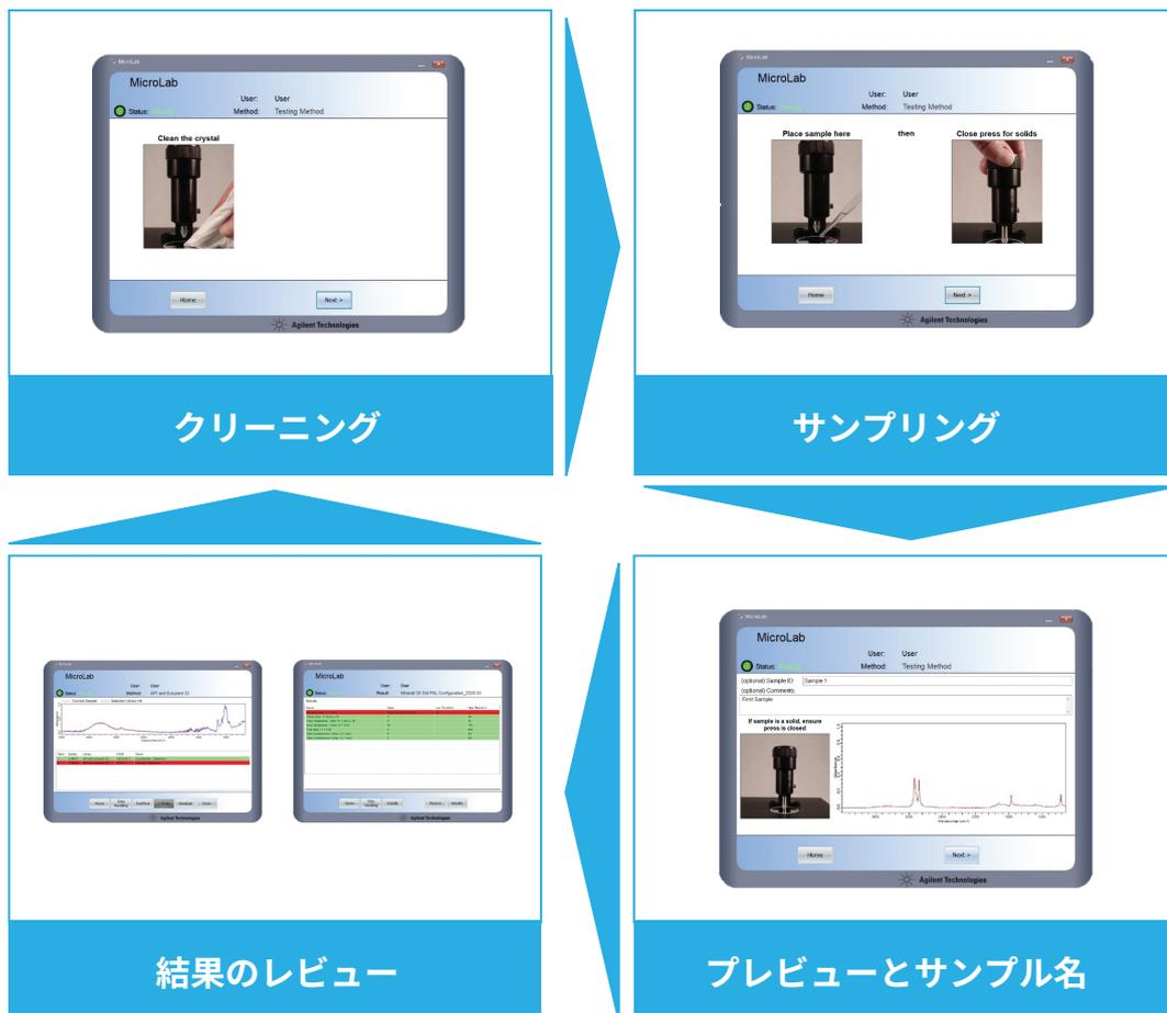
図 5. Agilent MicroLab ソフトウェアの画像ガイダンスインターフェースは、Agilent Cary 630 FTIR を使用した分析の実行を簡素化し、トレーニングの必要性を低減します。ソフトウェアは、機器の使用時にオペレータが見ているものと同じ画像を表示します。データ取り込みの後、図 6 および 10 で示されるように、結果が分かりやすいフォーマットですぐに表示されます。ユーザーが結果を確認した後、ソフトウェアでは次の分析が開始され、連続的な分析ワークフローが確保されます。
