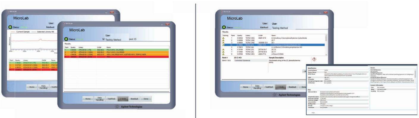
図 6. Agilent MicroLab ソフトウェアは、ライブラリ検索メソッドの結果画面が分かりやすく、経験が浅いユーザーでも確認して結果を解釈できるようになっています。左：ライブラリヒットデータが、リストのみで、またはリストとスペクトルで表示されます。右：危険情報やファーストレスポンス情報を含む化学物質メタデータのオプション画面も利用できます。
