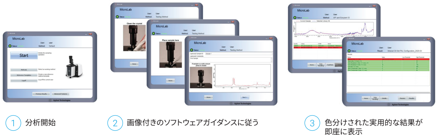
図 2. Agilent MicroLab ソフトウェアは、Agilent Cary 630 および 635 FTIR 分光光度計の操作を簡略化します。このソフトウェアは手順を画像で提供しているため、トレーニングの必要性を減らし、ユーザーベースのエラーのリスクを最小限に抑えます。
