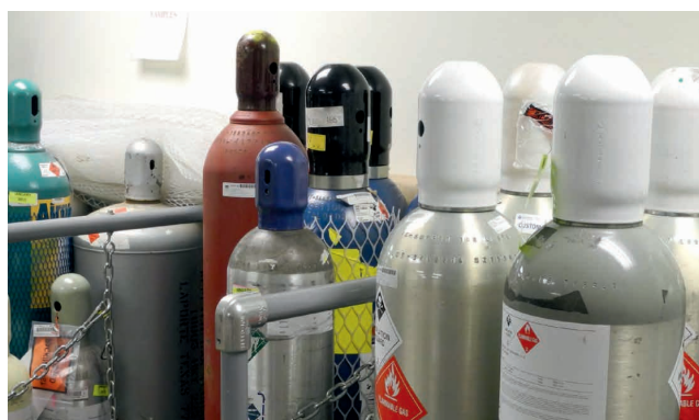
図 1. 多くの半導体産業用ガスは、有毒性、可燃性、または自燃性であるため、専用の GC サンプル導入が必要となります。
