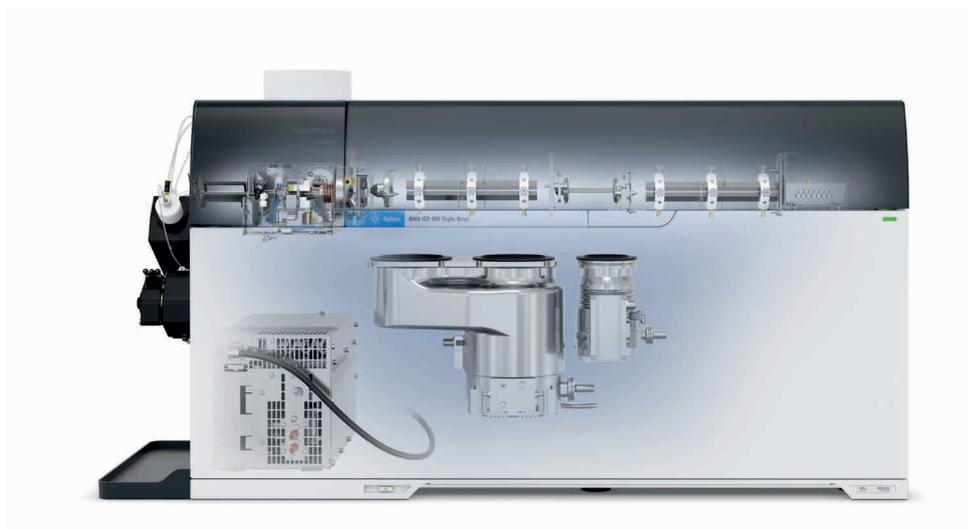
図 1. Agilent 8900 ICP-QQQ のタンデム MS (MS/MS) 構成
