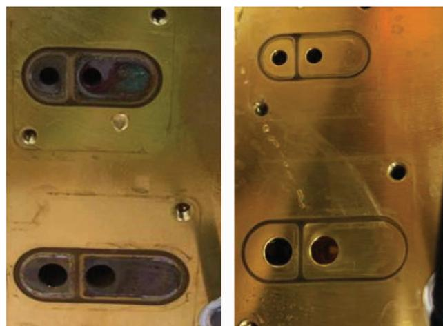
図 2. 冷却回路でさまざまな種類の流体を使用して数か月間運転した後の ICP-MS 冷却水マニホールド。左：非承認の冷却液を 2 か月使用した後。右：Agilent Cool Clear を 3.5 か月使用した後。
