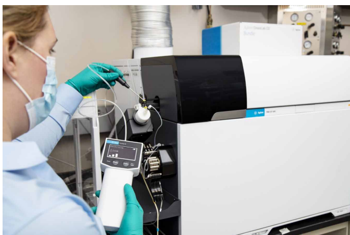
図 19. Agilent 7900 ICP-MS のネブライザフィッティングでのリークチェック
