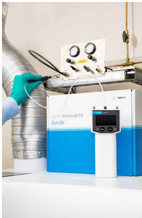
図 10. Agilent CrossLab CS リークディテクタを使用したアルゴンガスフィッティングのチェックの例
