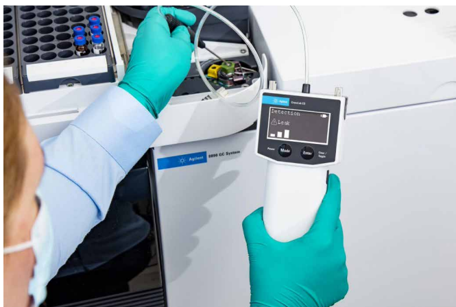
図 12. Agilent CrossLab CS リークディテクタを使用したガス注入口セプタムナットのリークチェック
