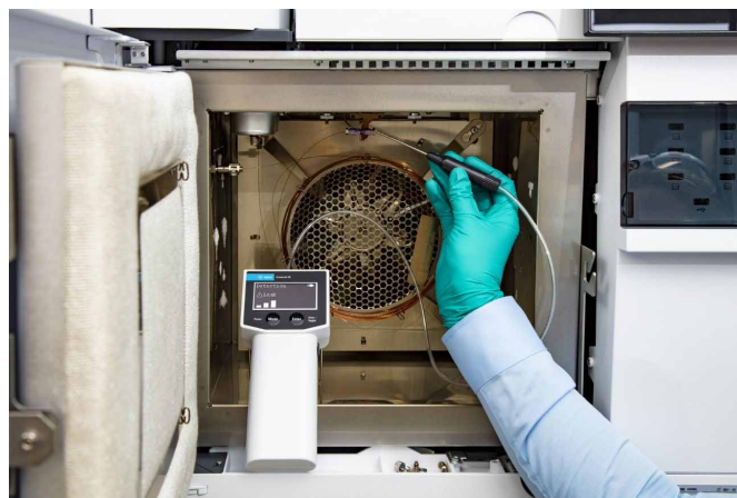
図 13. GC 注入口 (A) および Agilent キャピラリ・フロー・テクノロジー (CFT) 接続部 (B) でのリークのチェック
