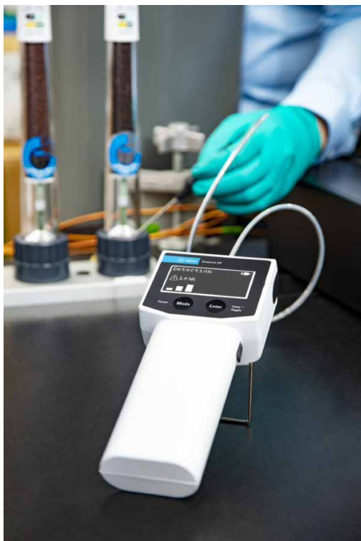
図 8. Agilent CrossLab CS リークディテクタを使用したガスクリーンフィルタユニットのリークチェックの例
