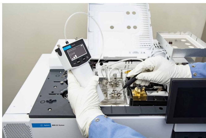
図 15. Agilent CrossLab CS リークディテクタを使用した、バルブ付き GC システムの接続部のリークチェック
