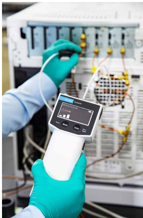
図 9. Agilent 8890 GC の背面にあるガスフィッティングのリークチェックの例
