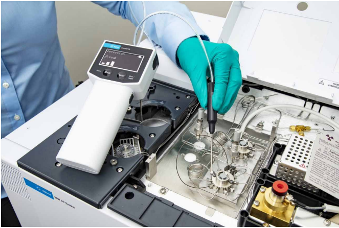
図 6. Agilent CrossLab CS リークディテクタを使用したパルスシステムのリークチェックの例。
