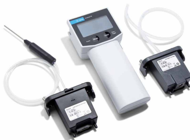
図 4. 交換可能なリークディテクタとフローメータカートリッジを備えた Agilent CrossLab CS バンドル
