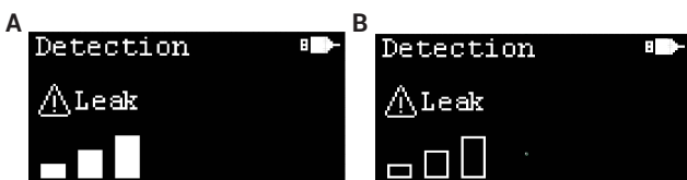
図 7. 空気よりも熱伝導率が高いガスのリーク (A) と空気よりも熱伝導率が低いガスのリーク (B) の例
