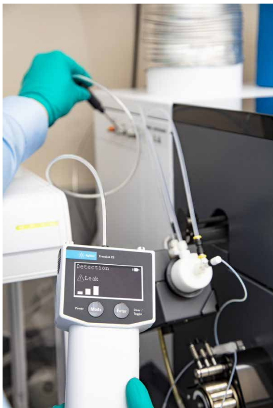
図 18. Agilent CrossLab CS リークディテクタを使用した Agilent 7900 ICP-MS のオプションガスポートでのリークチェック
