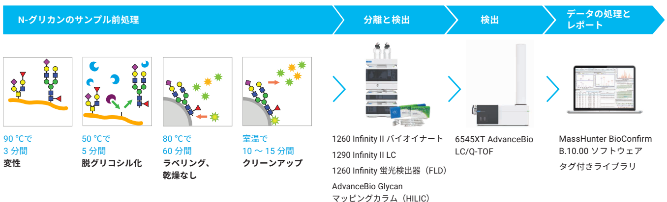
図 1. Gly-X 2-AB Express サンプル前処理と LC/FLD/MS を用いた遊離 N-グリカンの分析ワークフロー
