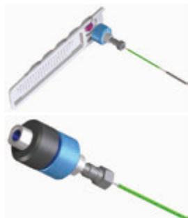
1. フィルタディスクの入っているタッチレスパッケージから、青いナット付きのフィルタハウジングにフィルタディスクを挿入します。
