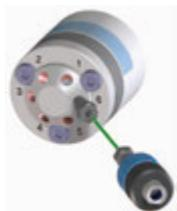
3. 製品に含まれるフィッティングを使用して、オートサンプラインジェクションバルブのポート 6\* にインラインフィルタを回し入れます。
