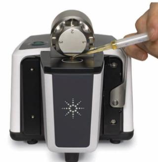
3 DialPath を目的の光路長にセット (回転) して測定します。
