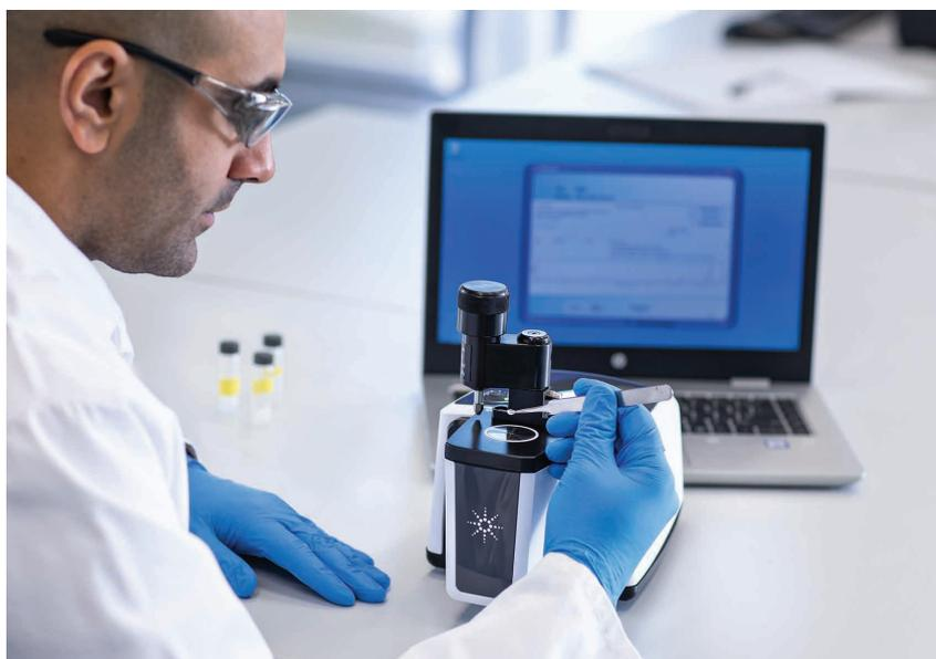
単一反射ダイヤモンド減衰全反射 (ATR) サンプルングモジュールを備えた Agilent Cary 630 FTIR 分光光度計。SBR およびポリエチレン酢酸ビニル (PEVA) コポリマーの分析に使用できます。
