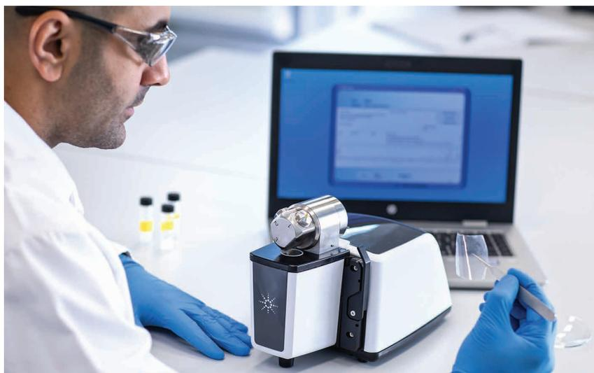
Agilent DialPath サンプリング技術は、ポリマークーボンやフィルムサンプルの分析を簡素化します。機器上部の銀色のアタッチメントが DialPath アタッチメントです。これにより、固定の光路長の透過率測定が可能になります。
