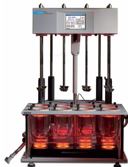
白色/赤色 LED を用いた画期的な照明システムとシールドにより、感光性のある製品も観察できます。
