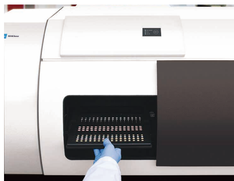
Agilent TRS 100 透過型ラマン定量 分析システム
