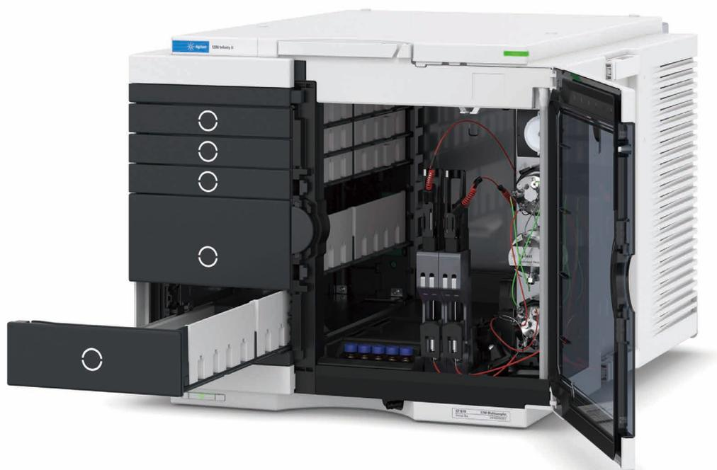
**図 15.** Agilent 1290 Infinity II マルチサンプラ。2 mL バイアルと 96 ウェルプレートと同じ引き出し内にセットできます。深い引き出しを使用すれば、より大きなサンプル容器を、また浅い引き出しを使用すれば、より多くのサンプルを収容できます。
