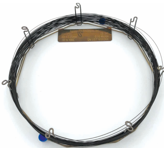
図 7B. 400 °C で 25 時間使用した後の Agilent J&W DB-5ht カラム
