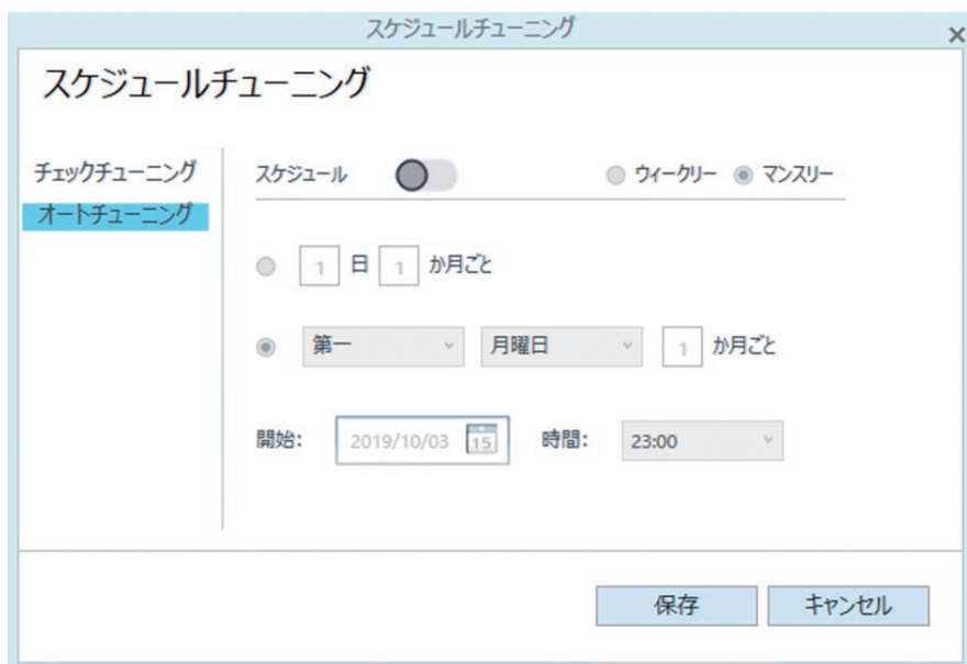
図 6. Checktune および Autotune は最適な MS 設定の測定と最適化を行います。 このプロセスは機器の待機中に自動的に実行されるようにスケジュールすることで機器の使用時間を最大化しつつ、最適なパフォーマンスを維持できます。
