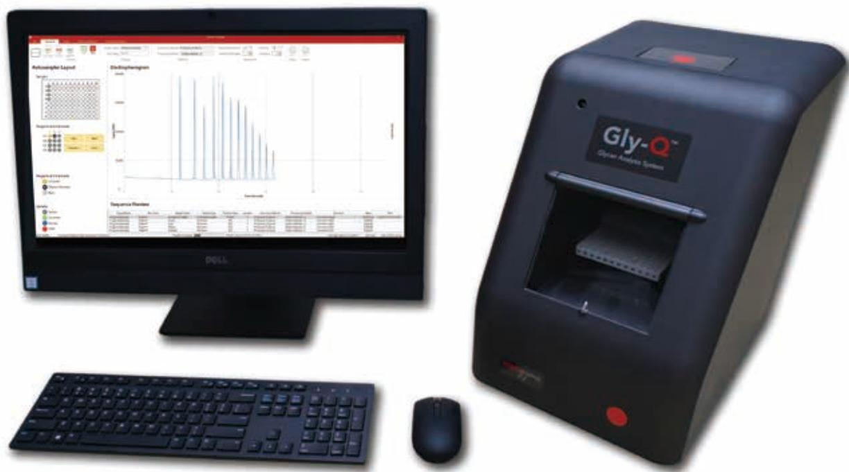
図 3: Gly-Q キャピラリーゲル電気泳動システムと Gly-Q Manager ソフトウェア
