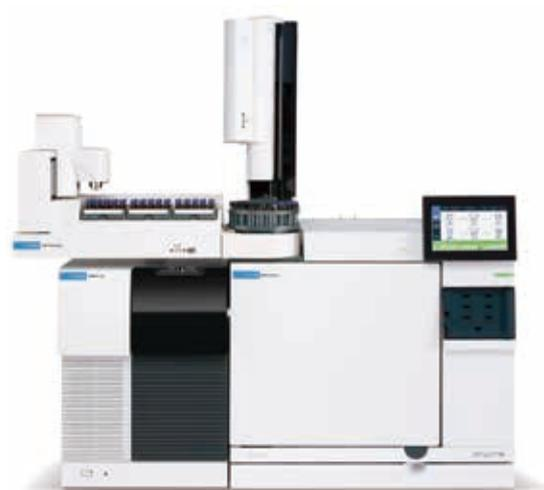
Agilent 8890A ガスクロマトグラフと Agilent 7000D 質量分析計との組み合わせは、4 fg のオクタフルオロナフタレンを検出できる機器検出レベル (IDL) 仕様を備えており、GC/MS/MS ルーチン分析に最適です。4 fg の IDL は設置直後の仕様で、システム全体 (ALS、GC、MS) の高い性能を実証するものです。
