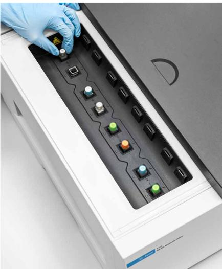
Cary 3500 マルチセル UV-Vis 分光光度計を使用すると、8つのチャンネルすべてで、全波長範囲を同時に1秒未満で測定できます。また、次の機能もあります。
