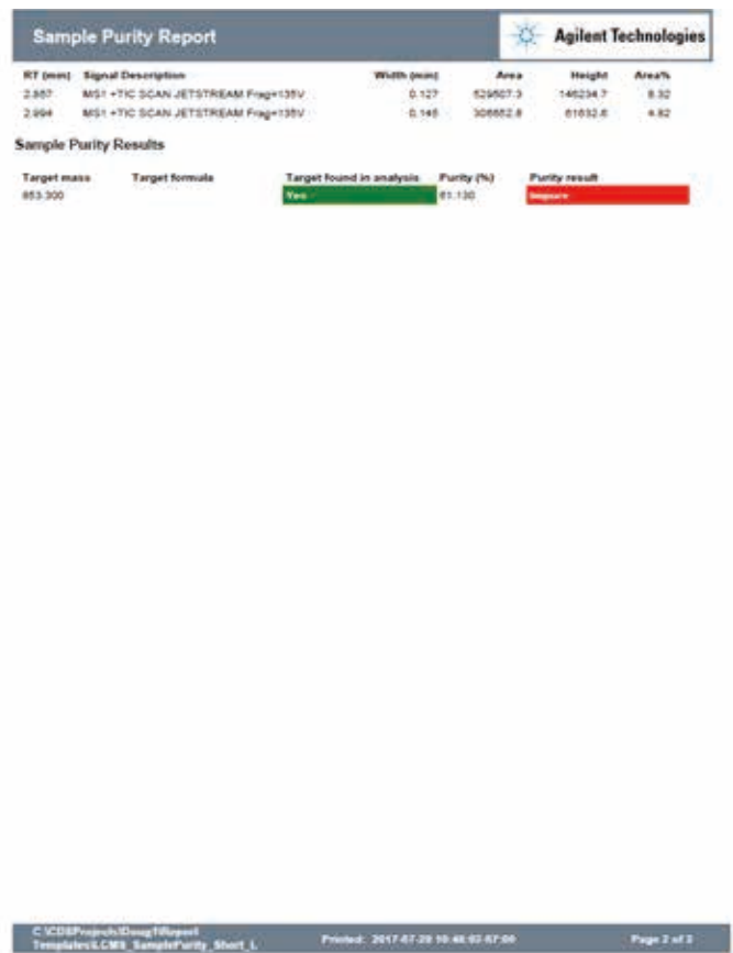
図 6. 典型的なサンプルの純度レポート。この場合、TIC シグナルに基づいて純度のカットオフ値 80 % を指定しています。パクリタキセルが検出 (緑表示) されましたが、サンプルでのパクリタキセルの純度は 61 % であり、カットオフ値を下回っています (赤表示)。
