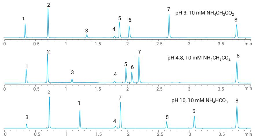
この例では、同一の酸性、塩基性、および中性化合物の混合物を低 pH、中 pH、および高 pH の移動相で分離しています。すべての化合物について最も高い分離能が高 pH 条件で得られました。このため、高 pH がこの分析の最適な選択肢となります。
