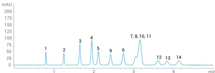
EPA 8330A メソッドパラメータを用いた爆発性物質の分析結果の比較です。InfinityLab Poroshell EC-CN 結合相と EC-C18 結合相で選択性が異なることがわかります。
