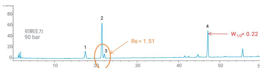
カラム以外はまったく同じメソッド条件で、より信頼性の高い結果を実現。この例では、使用カラムを InfinityLab Poroshell 120 4  $\mu\text{m}$  カラムに変えることにより、ピーク幅が 5  $\mu\text{m}$  の全多孔質カラムの半分になり、分離能が向上しています。
