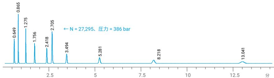
2.7  $\mu\text{m}$  Poroshell 粒子カラムでは、1.8  $\mu\text{m}$  全多孔質粒子カラムの半分の圧力で 90 % 以上の効率を得られています。
