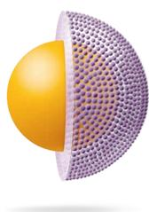
InfinityLab Poroshell 120 カラムには、硬質シリカコアと多孔性外殻で構成される表面多孔質粒子が充填されています。同じ、または同様の粒子径の従来型全多孔質粒子よりクロマトグラフィー効率に優れているため、高速での高分離能分離が可能です。
