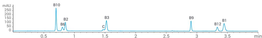
InfinityLab HILIC-Z カラムと HILIC-OH5 カラムでは、極性化合物の分離において広範囲にわたり異なる選択性が得られます。このクロマトグラムは、水溶性ビタミンの分離結果です。同じメソッド条件を使用して HILIC 結合相による選択性の違いを示しています。メソッド条件を変更することで、各カラムの分離性能を最適化することができます。
