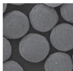
多孔性外殻をシングルステップで形成します。この独自プロセスにより、他社製カラムよりも高いカラム間再現性を実現しています。
