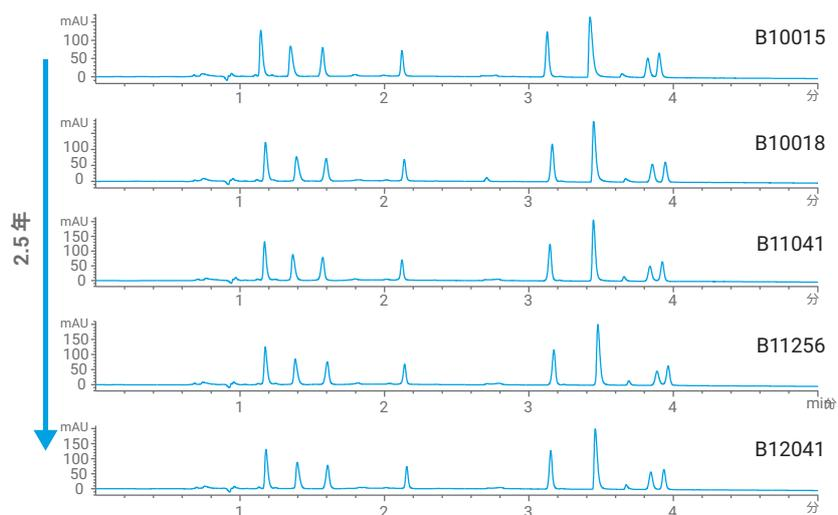
5つのロットの InfinityLab Poroshell 120 EC-C18、3.0 x 100 mm、2.7  $\mu$ m (p/n 695975-902) による分析
