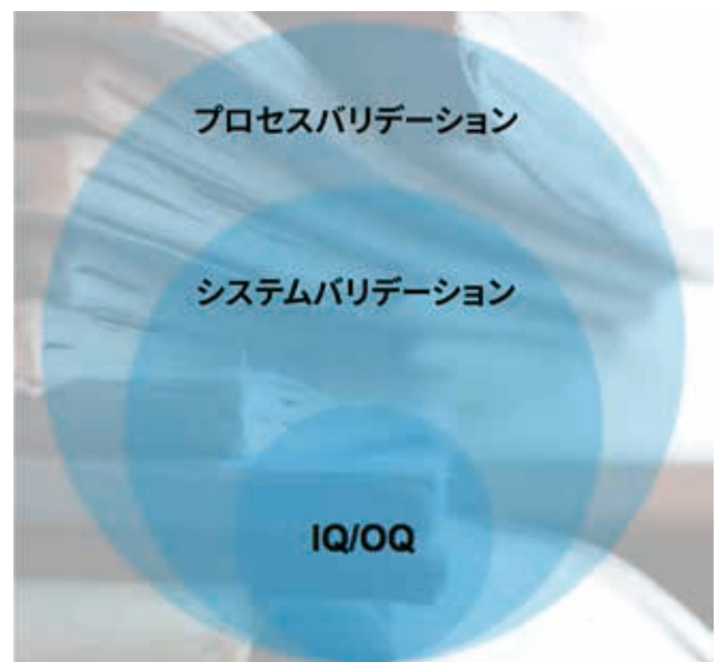
図 1. IQ/OQ、システムバリデーション、プロセスバリデーションの関係
