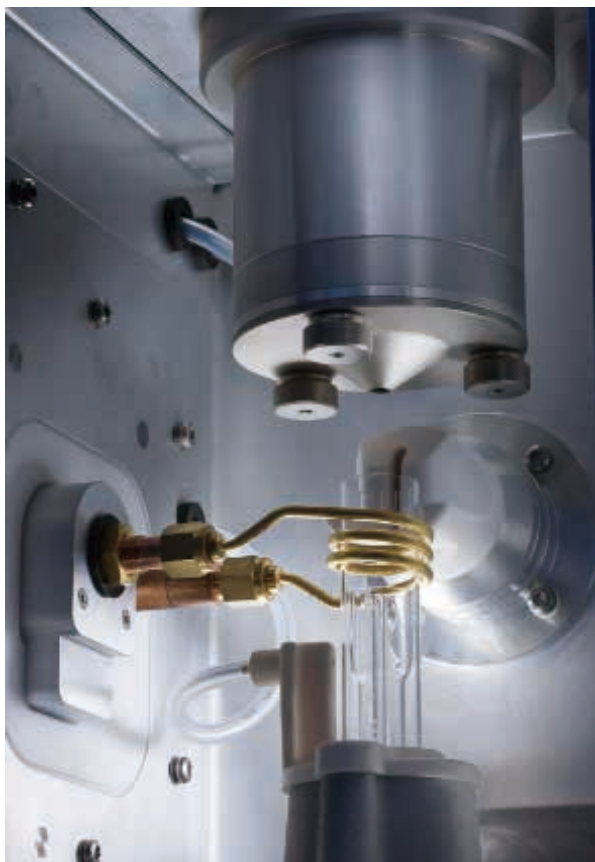
図 5. 5110 の垂直配置トーチは、水平配置トーチに堆積しがちな高濃度の溶解固形分を含むサンプルに最適です。
