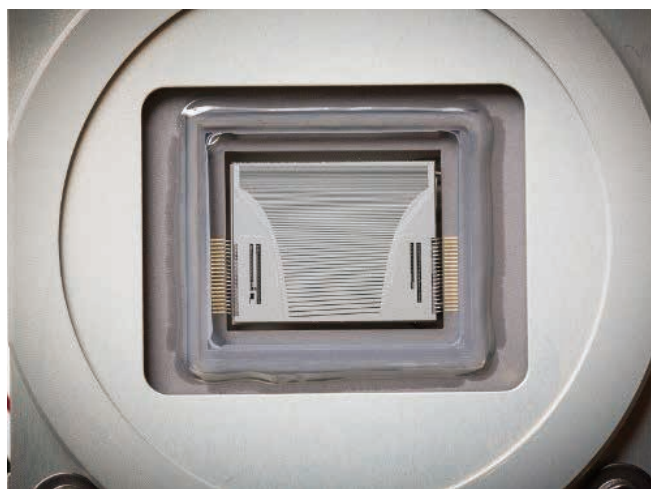
図 7. 検出器はハーマチックシール構造のため、UV 波長の測定時にアルゴンパージは不要です。このシール構造により、検出器の寿命も長くなります。
