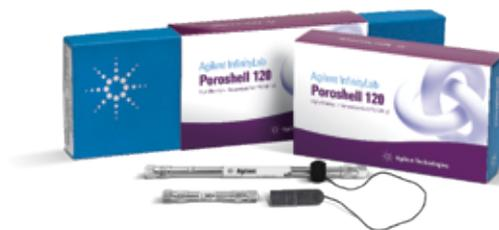
ID タグ付きの InfinityLab Poroshell 120 カラムは、1290 Infinity II LC に自動認識され、最終注入日、注入回数、使用した最高温度に関する詳細が一覧表示されるため、分析の追跡性が高まります。
