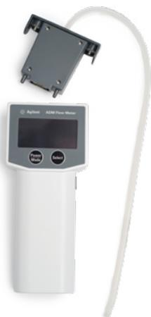
Agilent ADM フローメータは、流量のバリデーションや検出器の流量のトラブルシューティングにも最適です。スプリットベント、セプタムパージ、およびカラム流量の測定も可能です。
