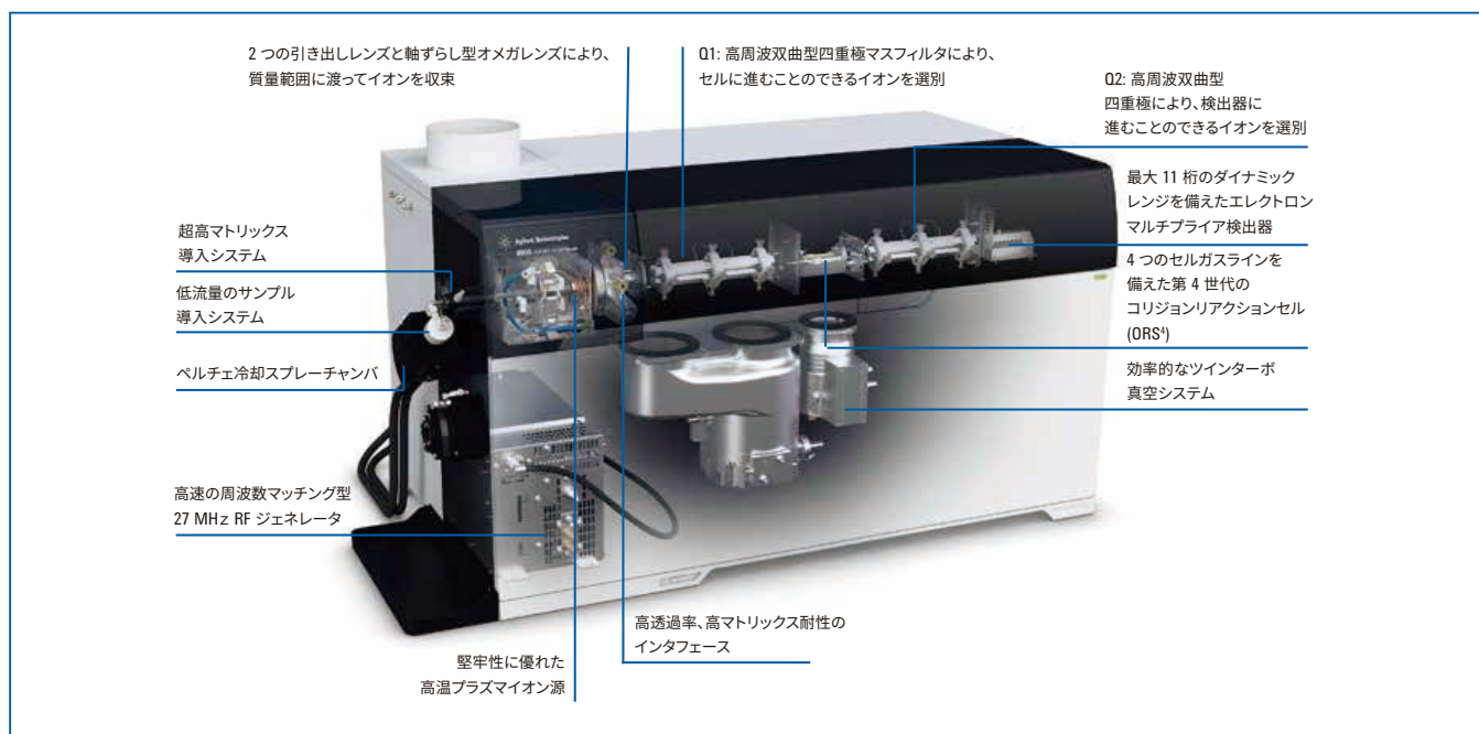
図 2. Agilent 8900 ICP-QQQ の主なハードウェアコンポーネントの概略図
