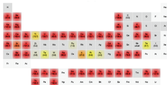
図 1. IntelliQuant で生成されるヒートマップには、サンプル中に存在する元素の相対濃度が視覚化されて表示されます。
