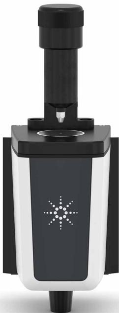
図 4. Agilent Cary 630 FTIR 用の ZnSe ATR アタッチメント
