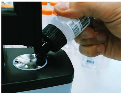
図 9. 希釈なしの消毒剤サンプルを、Agilent Cary 630 FTIR に取り付けられた ATR アタッチメント上に置きます。Agilent MicroLab ソフトウェアでは、ユーザーがクリーニングやサンプリングを含む測定の各ステップを踏めるよう、画像ガイド付きのワークフローを採用しています。
