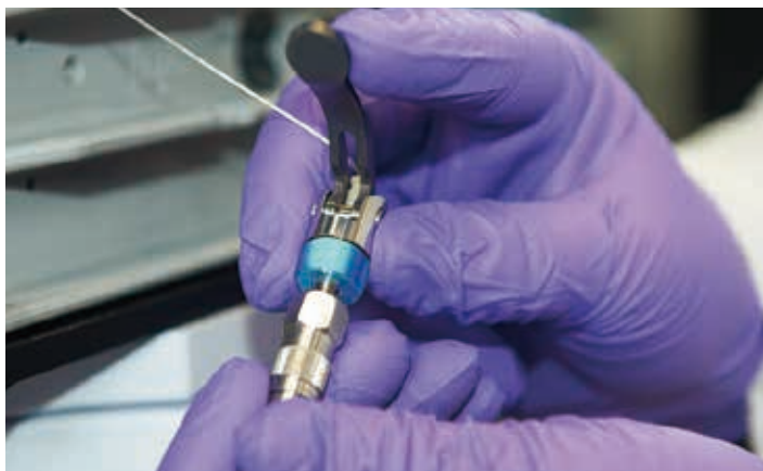
内蔵スプリング構造を採用したアジレント独自の設計により、正確かつ確実にゼロデッドボリュームの接続が可能になります。
