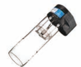
銅 (Cu) 単元素、50 mm 径 ホローカソードランプ、8003-0894
