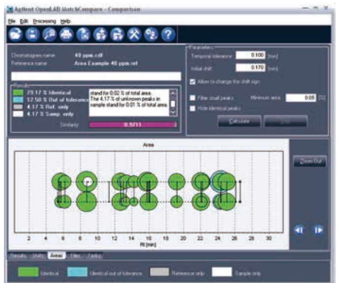
OpenLAB MatchCompare のグラフィカル比較では、クロマトグラム全体の一致スクリーニングを実施して、違いを迅速に視覚化できます。
