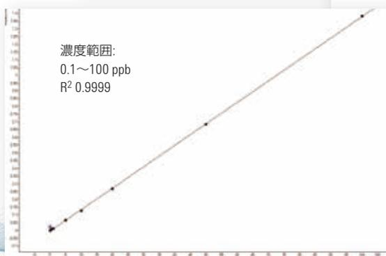
Agilent 7000C GC/MS を用いて作成したマトリックス中ホレートの検量線。0.1~100 ppb の範囲における R<sup>2</sup> 値は 0.9999 でした。
