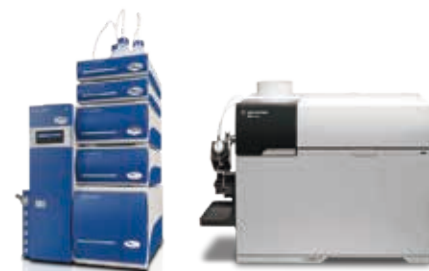
PostNova AF2000MT AF4 FFF システムに連結した Agilent 7900 ICP-QMS
