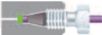
C: 適切に取り付けられたチューブ - デッドボリュームなし
