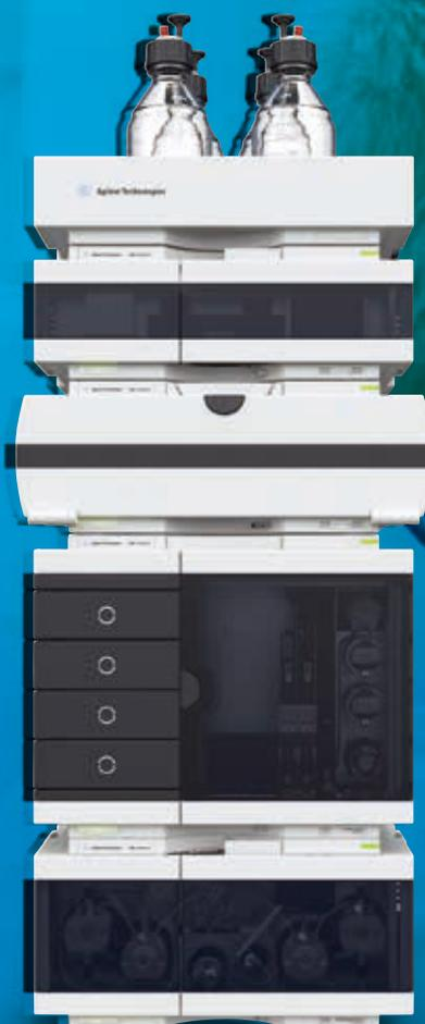
「Q-ToF は、豊富なデータを提供し、安定した高精度な質量測定により、非常に狭い範囲で抽出イオンスペクトルが得られ、ノイズをゼロに近い値まで低減できます。また、未知化合物の分子式を精密分子量から求めることができます。MS および MS/MS のいずれのモードでも優れたリアリティおよびダイナミックレンジを有し、定量分析が可能です。また、付属ソフトウェアを使用すれば、データベースやライブラリ検索を容易に実行できます。文献やメディアで報告された新しい化合物を、検索可能なデータベースに追加するだけで、古いデータでレトロスペクティブ検索することもできます。」
