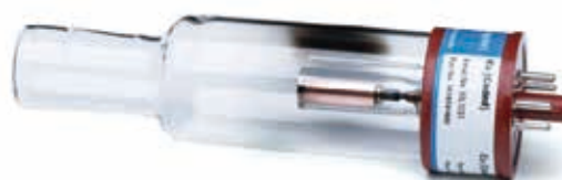
図 3. アジレントのランプの中に見える黒いスポットは、アクティブな「ゲッター」スポットで、ランプの寿命を延ばし、いつまでもスペクトル純度を保つために、意図して作成されたものです。
