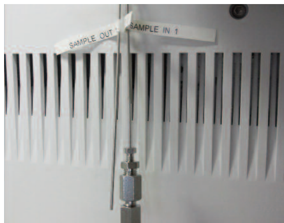
図 1. 流路の 1/16 インチステンレストランスファーラインの例。活性 (反応性) の高い化合物を分析するには、これらを不活性化する必要があります。
