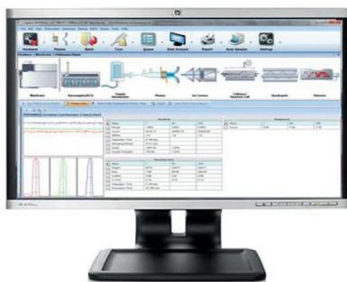
最新バージョンの ICP-MS MassHunter ソフトウェア (バージョン 4.1) が、新しい Agilent 7900 四重極 ICP-MS と併せて開発されました。このソフトウェアを使えば、構成、メソッド設定、データ採取、データ処理、レポート作成を完全にコントロールできます。
