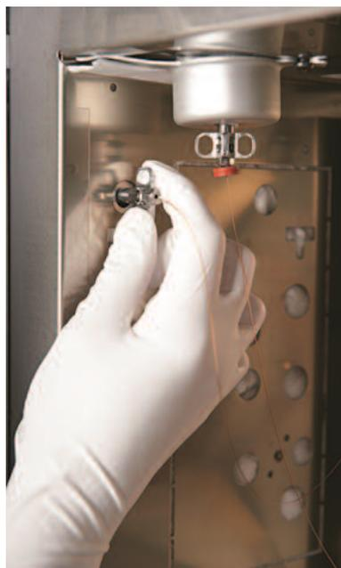
図 3. トランスファーラインと注入口フィッティングに設置したセルフタイトカラムナット
