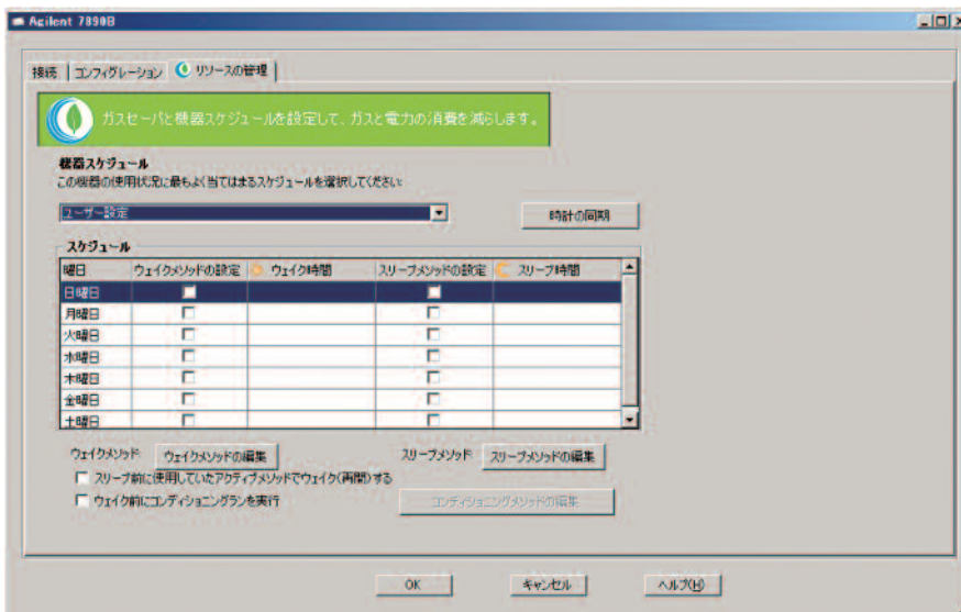
図 4. 機器スケジュール画面でのスリープ/ウェイクパラメータの設定
