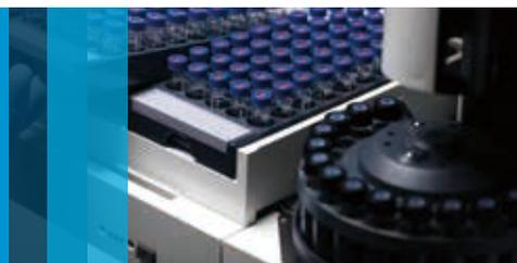
Agilent 7693 シリーズオートサンブラ (ALS) はあらゆる GC オートサンブラの中で最高の注入速度を実現します。7693A プラットフォームは、必要に応じて小さいサンプル負荷量と高いサンプルスループットを備えた再現性の高い 16 本または 150 本のバイアル容量を提供します。自動化された希釈、内部標準の添加、加熱、混合、および溶媒添加などの拡張機能によって作業者間のばらつきをなくし、前処理作業のやり直しを削減します。
