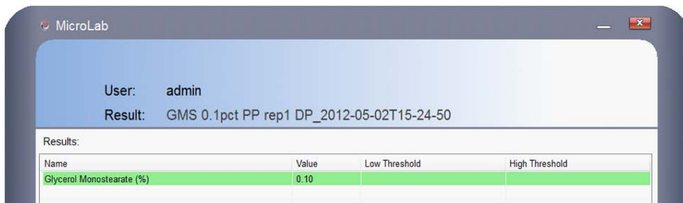
図 7. ポリプロピレンに含まれる 0.1 % GMS の MicroLab PC FTIR ソフトウェアによる予測値
