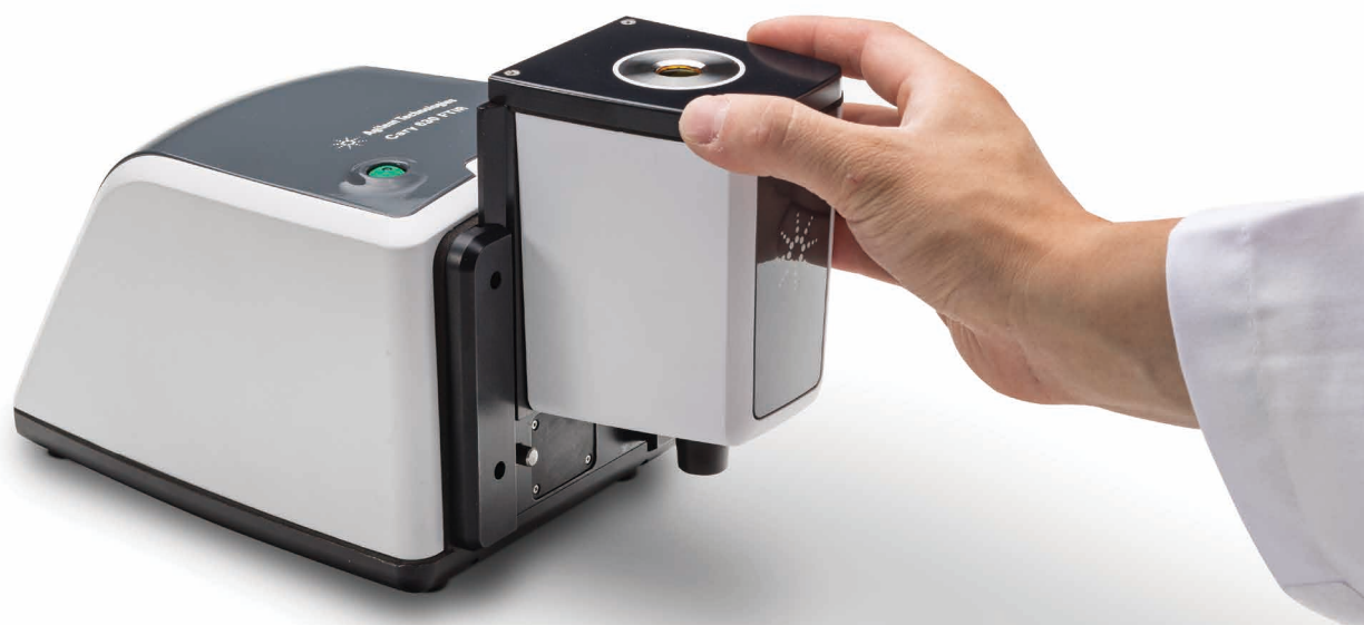
着脱の容易な各種アタッチメントは、数秒でスライドして着脱させることが可能で、調整も不要です。図に示されているのは、多重反射型 ZnSe ATR アタッチメントです。
