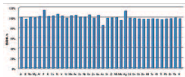
図 1. TCS における 5 ppb 添加回収試験。サンプル蒸発中に揮発性元素が失われていないことが確認され、すべての分析対象元素で良好な回収率 (80~120 %) が得られています。
