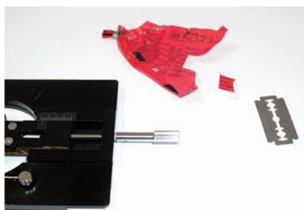
ステップ 1. サンプル片を切り出します
